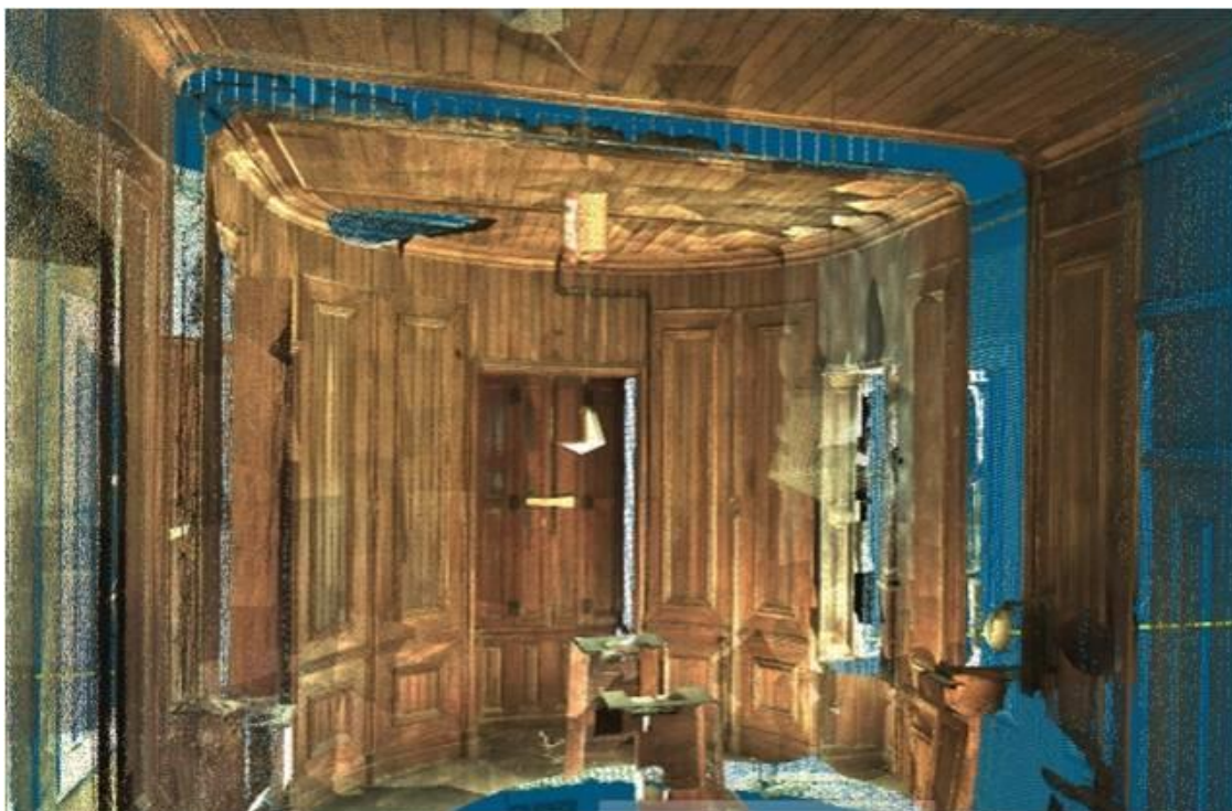
Figura 10 – Nuvem de pontos laser da sala da meridiana mostrando a abertura ao longo do meridiano.
